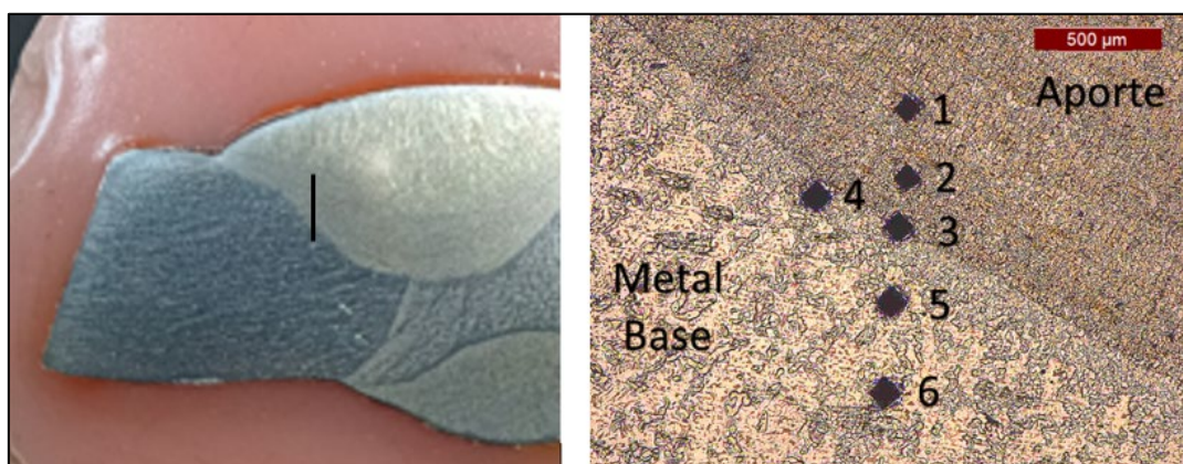
Imagen 18 - Imagen microscopio óptico – soldadura - codo inferior – cordón longitudinal
