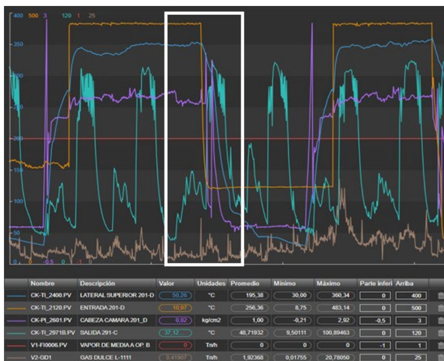
Imagen N°3 – Comportamiento de las variables durante el enfriamiento de cámara de coke D-201
