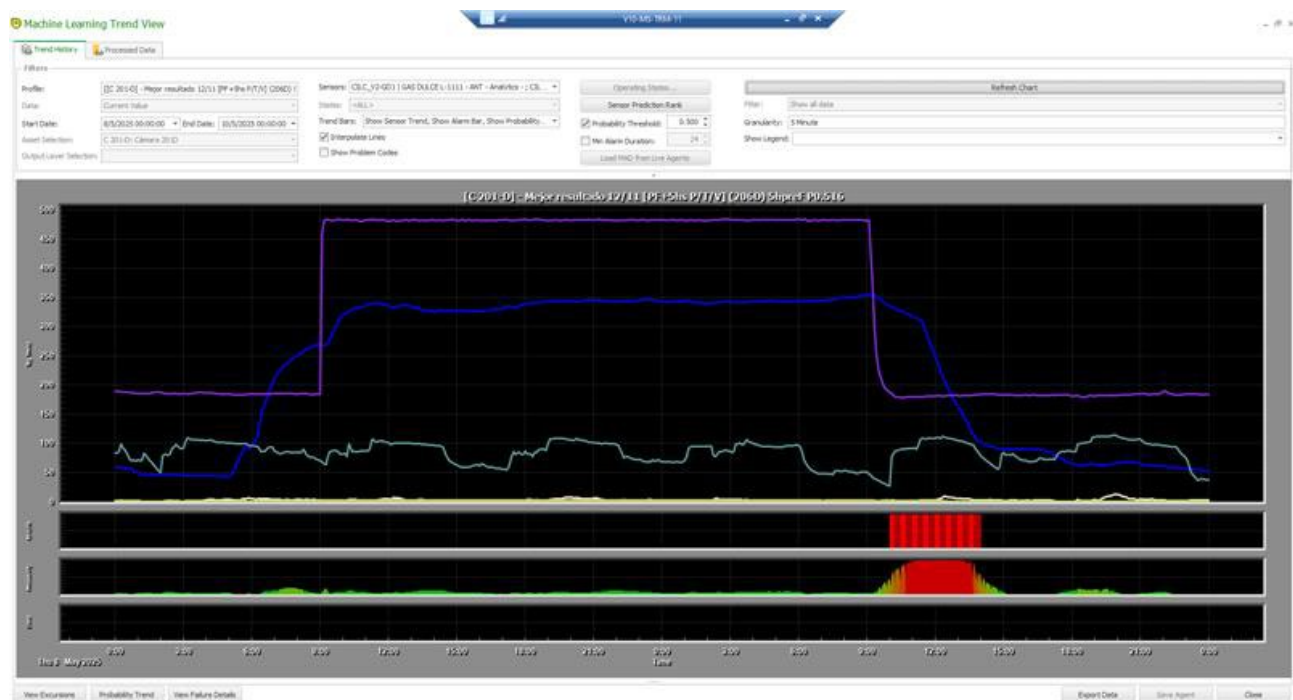
Imagen N°4 – Gráfica que entrega la herramienta Mtell luego del entrenamiento, de detección del periodo de enfriamiento de la cámara D-201
