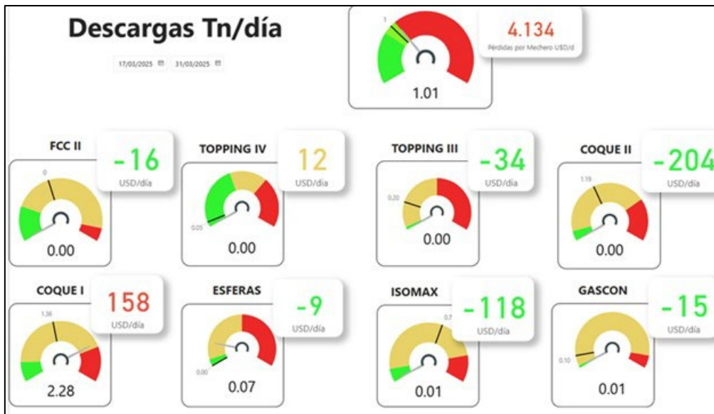
Gráfico N°12 – Indicadores de descarga unificados por planta con la sumatoria de los promedios de las ultimas 12 horas expresados según costo de mermas gaseosas.
