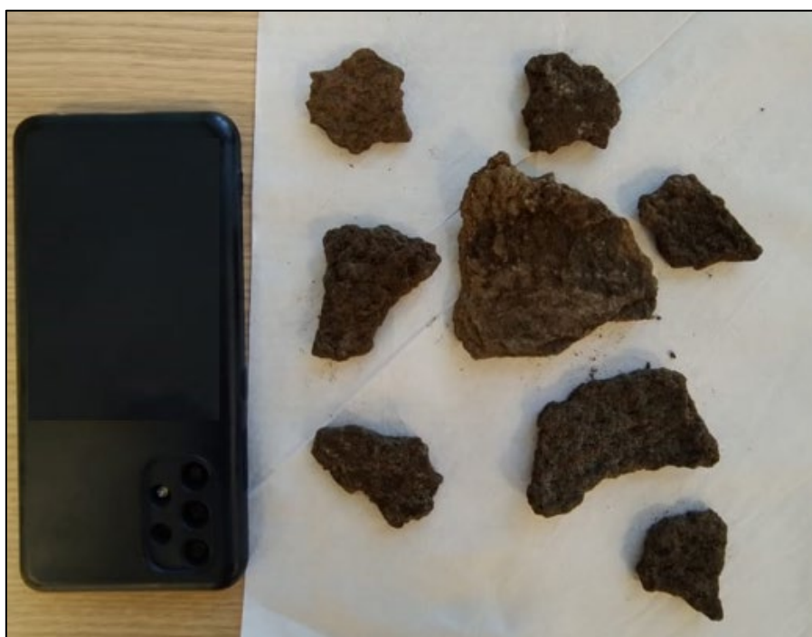
Figura 9: Suciedad obtenida en Filtro de bomba de extracción de kerosene durante el lavado de T1.
