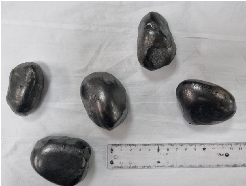
Figura 5. Piedras de carbón encontradas en las inmediaciones de los inyectores de carga.
