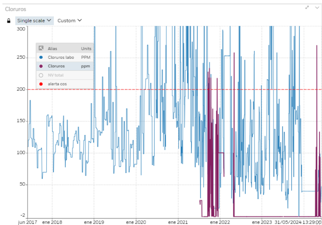
Figura 2: Concentración de Cloruros en la bota del 2do acumulador de cabeza (línea punteada roja el valor de la ventana de operación segura MAX 200 ppm)
