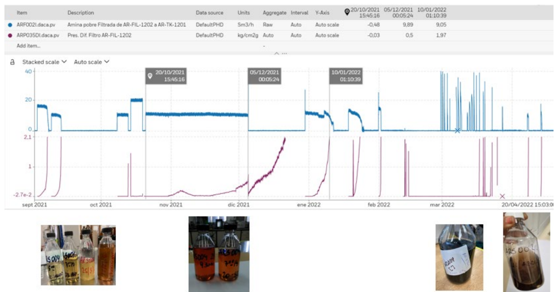
Figura 4: Relación de la coloración con la saturación de los filtros de Aminas
