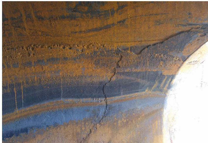
Vista del escalón formado en el perfil que forma la espuma. Se pueden ver pits redondeados de 6 mm de diámetro lo que da la idea de la presencia de \text{CO}_2 en el gas.
