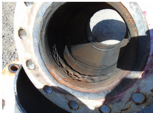
Figura 15: Resultado del corrosión mapping y la inspección del sistema de cañerías de conexión entre la torre AR-T-1201 y el reboiler AR-E-1202
