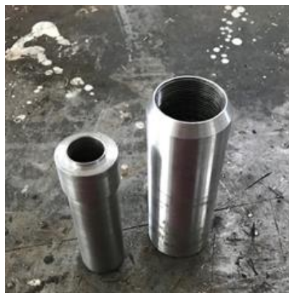
Figura 6 - Herramienta de golpe desarmada.
