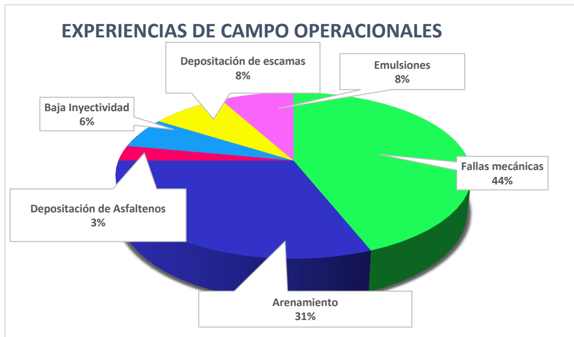
Fig 1 - Frecuencia de los problemas operacionales de la Inyección cíclica de Vapor, Roa et al (2007)
