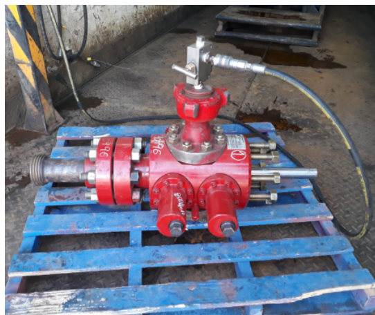
Fig. 9: Prueba hidráulica a 10 Mpsi entre los rams.
