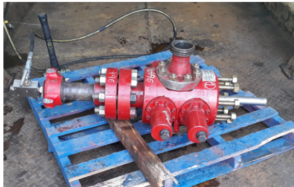
Fig.8: Prueba hidráulica a 10 Mpsi en el sentido de flujo y aplicada sobre el área transversal del vástago.
