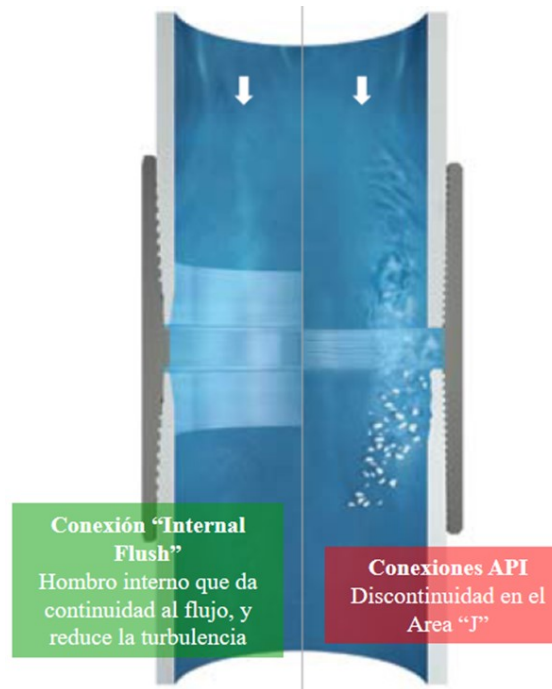
Fig. 9: Efecto sobre el flujo al utilizar conexiones con hombro interno.
