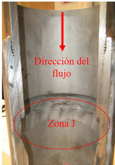
Fig. 8: Izq. Esquema de conexión API LTC (según API 5CT). Der. Daño por erosión en zona "J", test descrito en paper SPE 147514.
