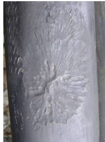
Fig. 2: Daño por erosión en superficie externa de tubing 2 7/8" N80.Q, debida al jet en zona de punzados de un pozo con bombeo electrosumergible (casing 5 1/2").
