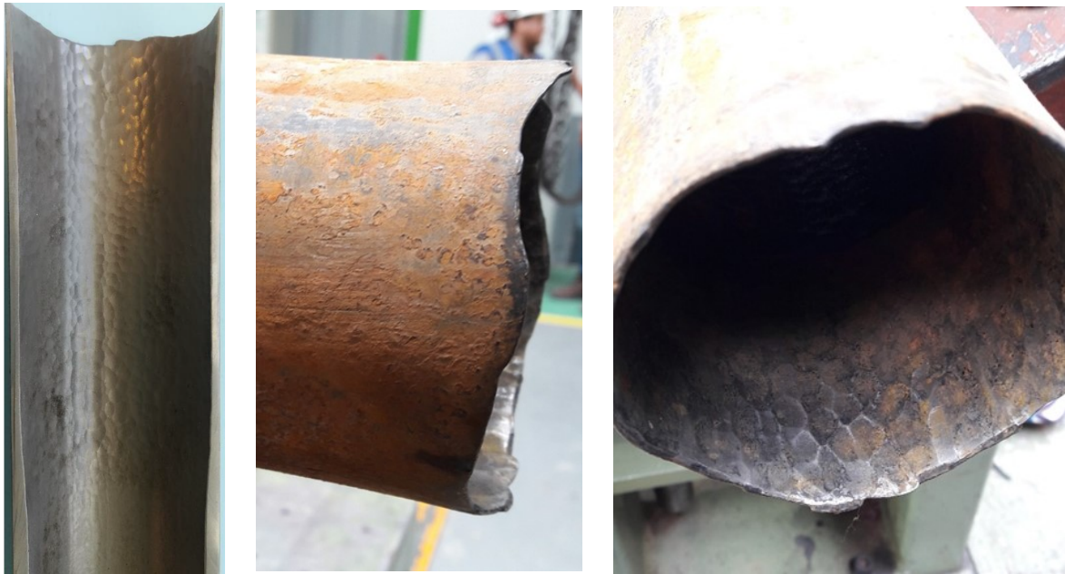
Fig. 13: Estado de la falla del casing 3 ½” 10.2# P110 luego de las operaciones de fractura (CASO 5). Se observa la morfología de daño tipo “panal de abejas” en la superficie interna del tubo.
