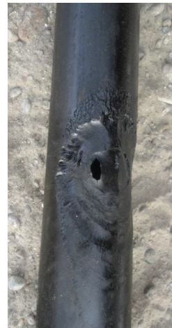
Fig. 2: Daño por erosión en superficie externa de tubing 2 7/8" N80.Q, debida al jet en zona de punzados de un pozo con bombeo electrosumergible (casing 5 1/2").
