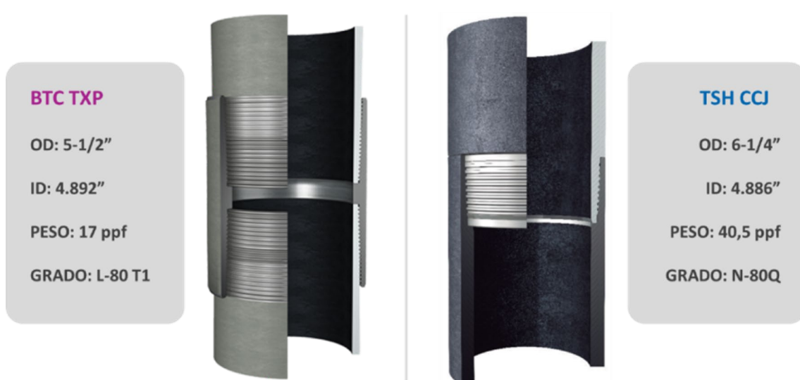
Imagen 2 - Esquema comparativo entre conexión TXP BTC y TSH CCJ
