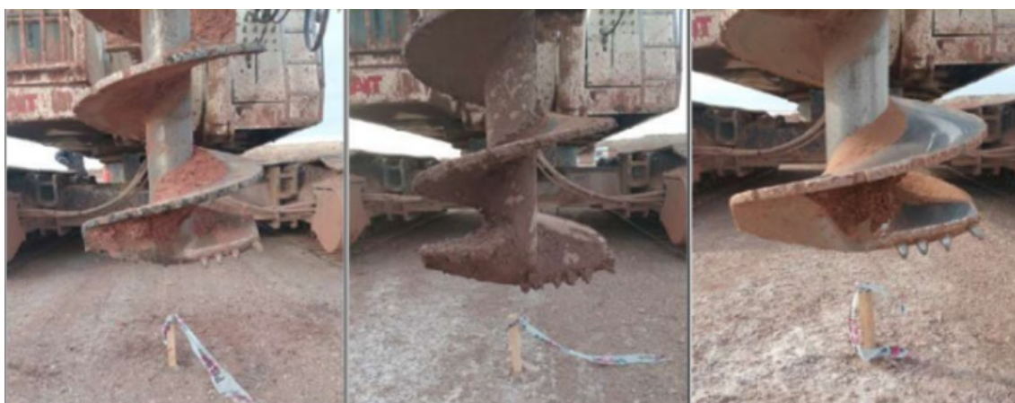
Imagen 15. Maquinaria de corte de perforador de conductores.
