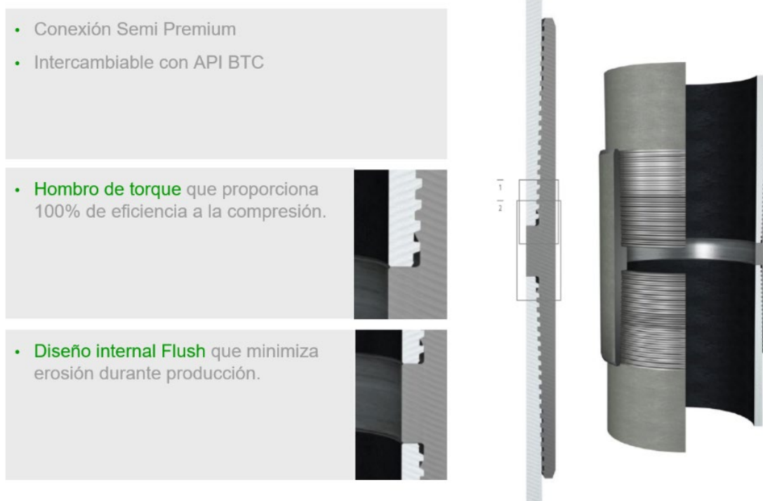
Imagen 5 - Conexión TXP® BTC – Cuplada con hombro de torque
