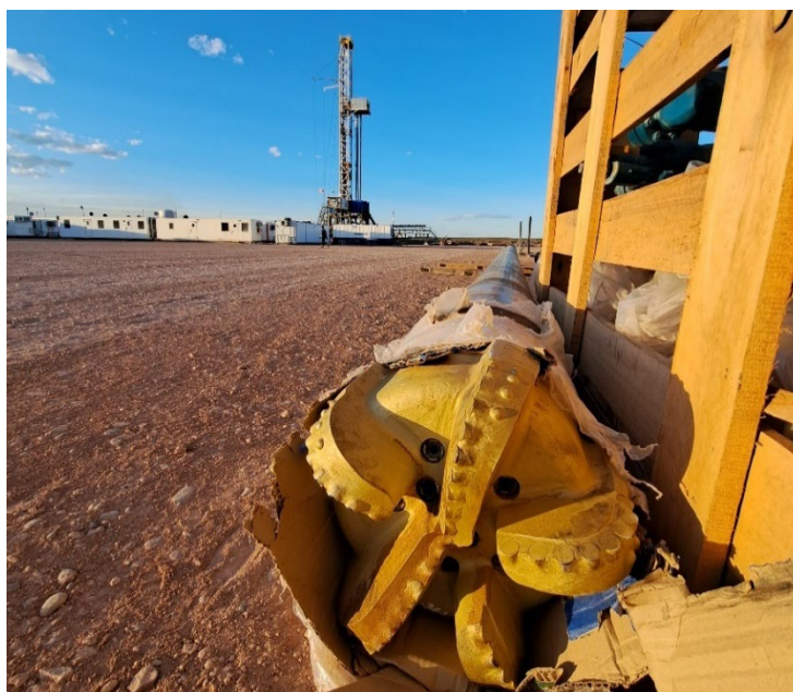
Imagen 7 - Conjunto Tubo-Collar-Zapato perforador en locación
