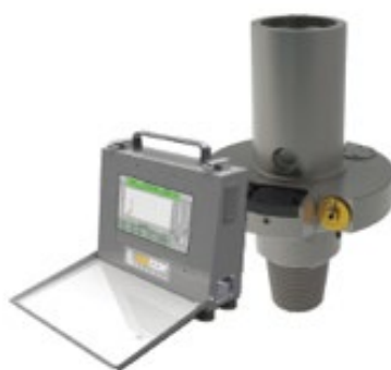
Imagen 6 - Torque Tension Sub, dispositivo de medición en alta frecuencia.
