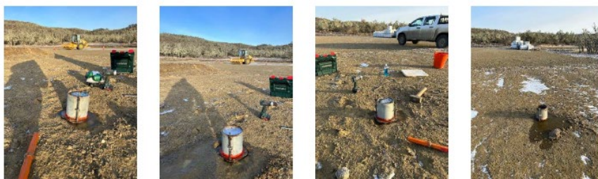
Figura 2: Ensayos de permeabilidad del suelo de la playa de secado
