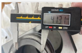
Fig. (29) Daño en asiento de válvula 2 9/16 plg (0.065 m) 10000 psi (703 kg/cm 2 )
