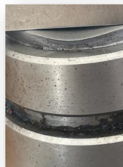
Fig. (29) Daño en asiento de válvula 2 9/16 plg (0.065 m) 10000 psi (703 kg/cm 2 )
