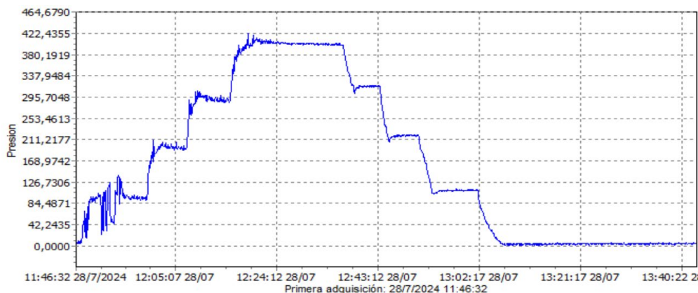
Figura 14. Presurización por anular, hasta alcanzar 400 psi, en primer pozo con 634WEA
