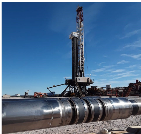
Figura 5. Sistema de sellado, Metal Expandable Packer, con 3 sellos redundantes listo para ser instalado en pozo.
