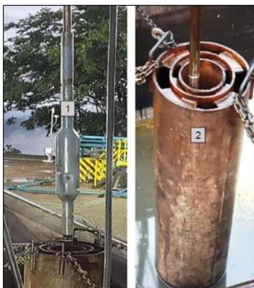
Ilustración 8. Configuración de completamiento con BHA sand jetting posicionado (Yard test).
