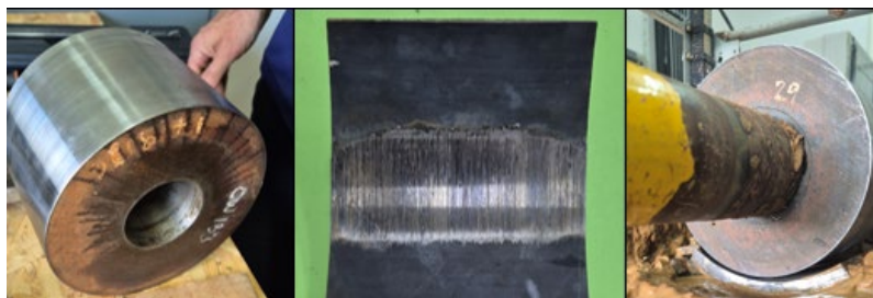
Figura 4 – Elemento rotativo y teja de casing ensamblados para la prueba.
