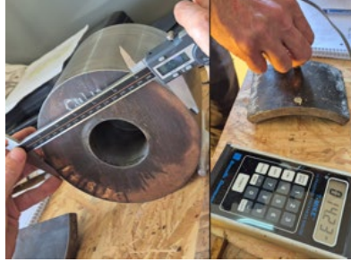
Figura 7. Control dimensional del elemento rotativo y casing
