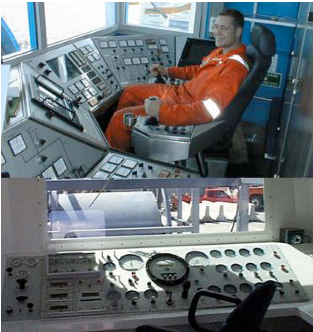
Fig. 7 - Cabina de Control de Unidad de Tubería Flexible
