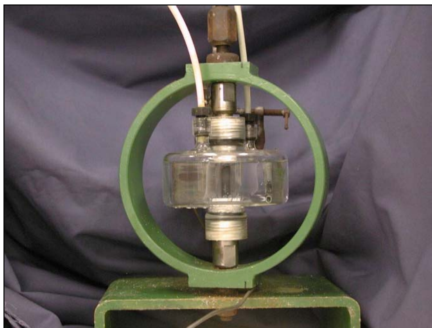
Figura 2 – Cámara de prueba para NACE Método A (Foto cortesía de Honeywell).
