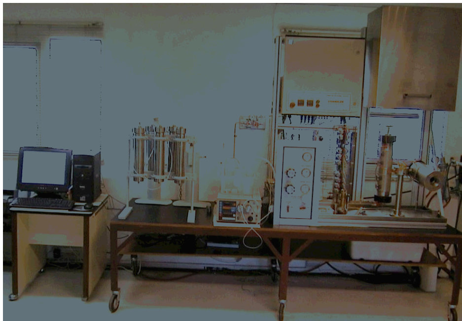
Figura 3. Equipo FRT 6100 utilizado para los ensayos de recuperación de permeabilidad.
