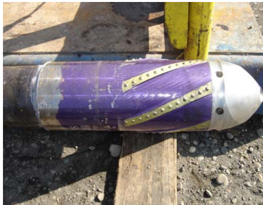
Fig.10 Zapato rotador de 8 5/16" utilizado en la corrida de csg 7"
