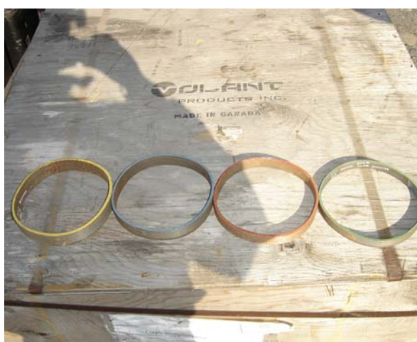
Fig. 8 Sistema de Top rings utilizados para aumentar el torque nótese la existencia de 4 clases de los mismos que utilizados de acuerdo a la profundidad del espejo de la cupla el cual se mide con la regleta arriba indicada
