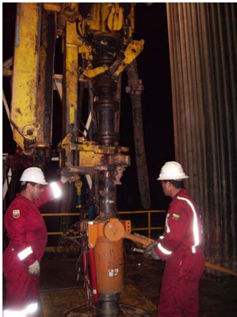
Fig. 4. Sistema de chequeo brazos hidráulicos Casing Drive
