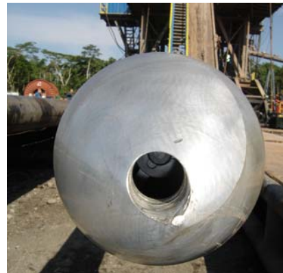
Fig.10 Zapato rotador de 8 5/16" utilizado en la corrida de csg 7"
