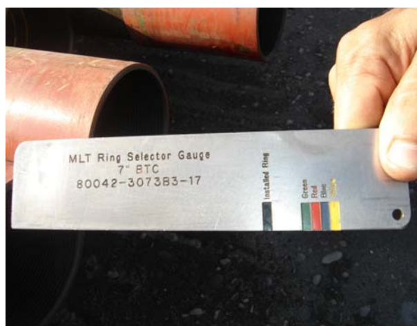
Fig. 8 Sistema de Top rings utilizados para aumentar el torque nótese la existencia de 4 clases de los mismos que utilizados de acuerdo a la profundidad del espejo de la cupla el cual se mide con la regleta arriba indicada
