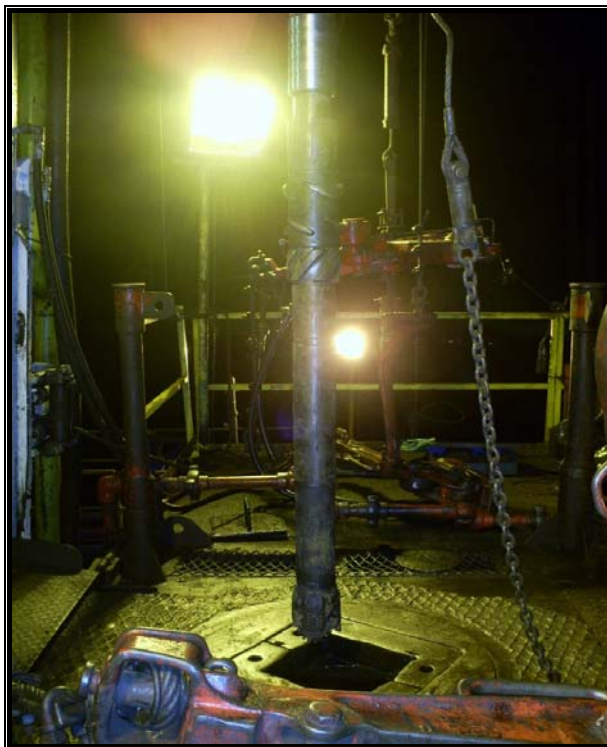
Fig. 13. Bajando BHA de Limpieza
