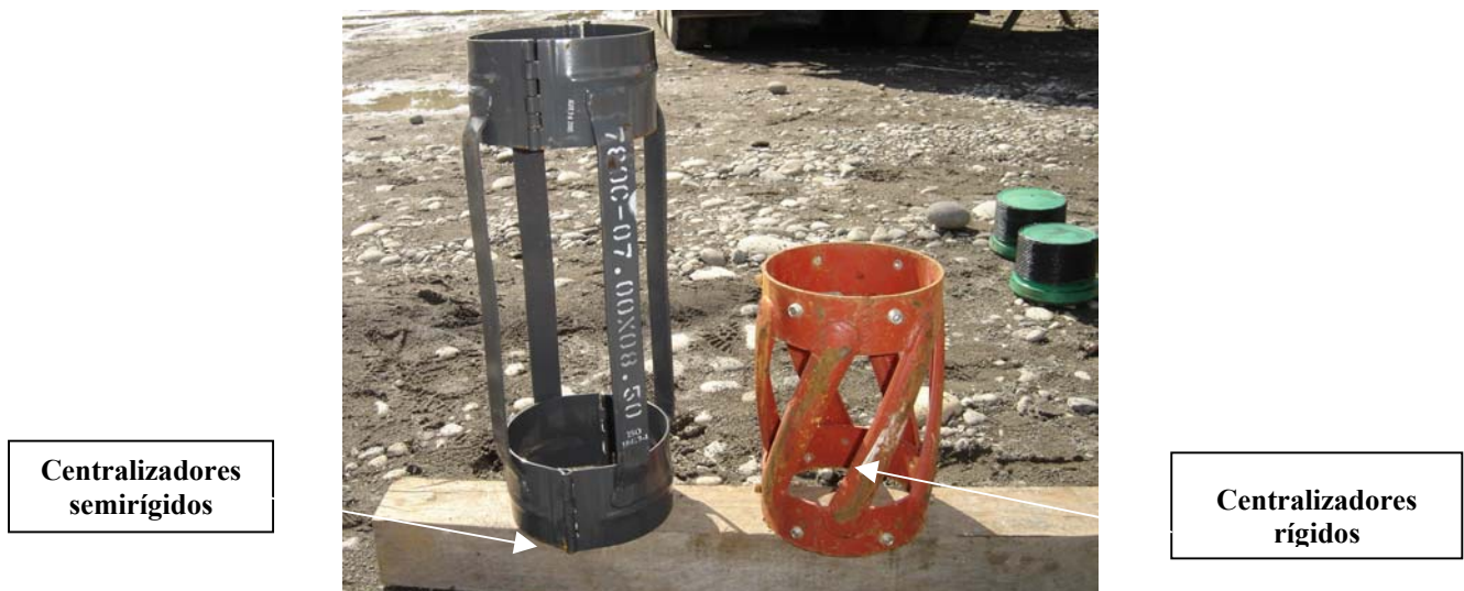
Fig.9 Centralizadores en locación se utilizó los centralizadores rígidos de color rojo de la derecha
