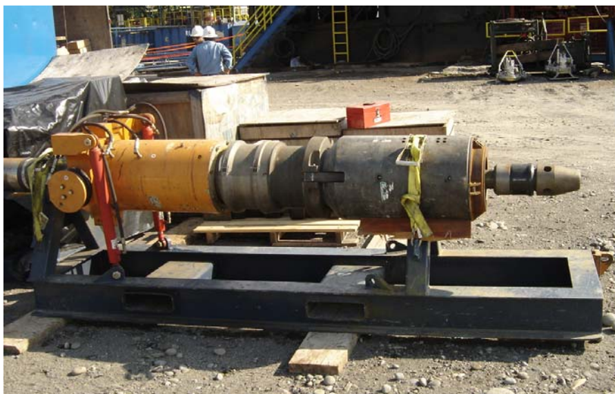
Fig. 6 Sistema de Casing Drive
