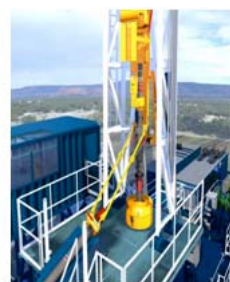
Fig 3 Sistema robotizado de corrida de revestimiento "Casing Running"
