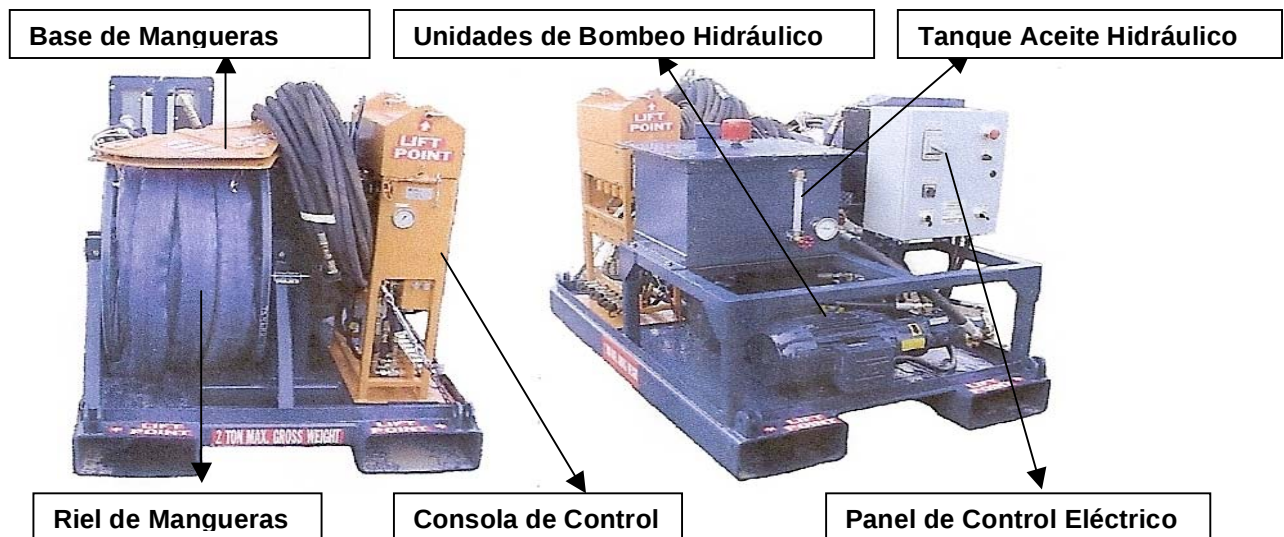
Fig. 15 Unidad de Potencia Hidráulico
