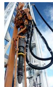
Fig 3 Sistema robotizado de corrida de revestimiento "Casing Running"
