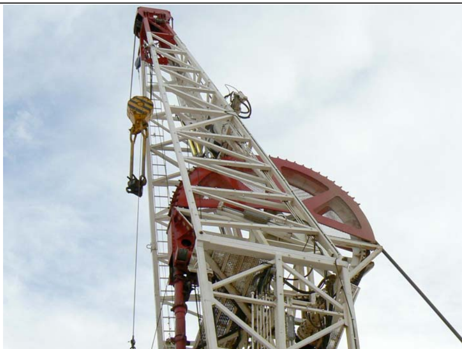
Fig. 4: Mástil del Equipo de Coiled Tubing.
