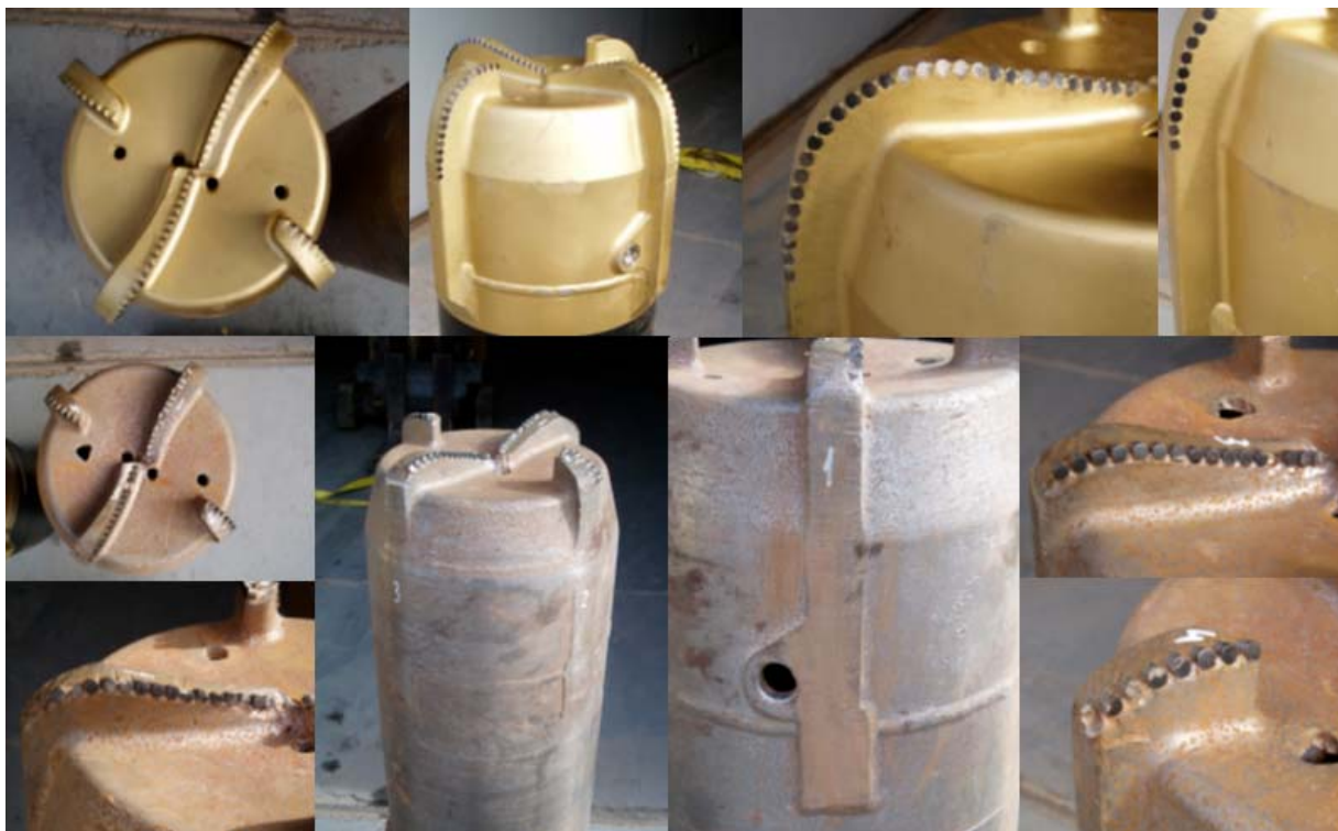
Foto1. Trépano 16" EZC304 antes y después de la carrera de 126m en 34.58 hs @ 3.64 m/h
