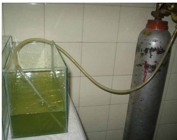
Figura 1. Fotobiorreactores con inyección de anhídrido carbónico
