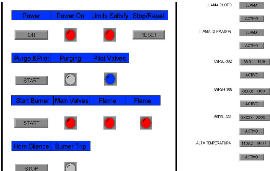
Figura 12: Panel de Control Local del Horno
