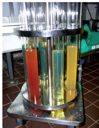
Gráfico 18. Evolución del color de un B5 por oxidación (TOTAL ACS)
