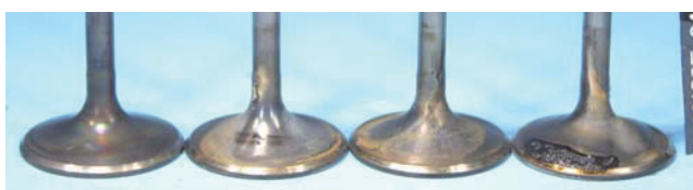
Gráfico 22. Válvulas de admisión tras ensayo M102E. Gasolina E85 sin y con aditivo detergente.
