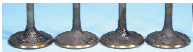
Gráfico 22. Válvulas de admisión tras ensayo M102E. Gasolina E85 sin y con aditivo detergente.
