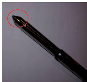
Gráfico 19. Formación de lacas en la aguja de un inyector (TOTAL)
