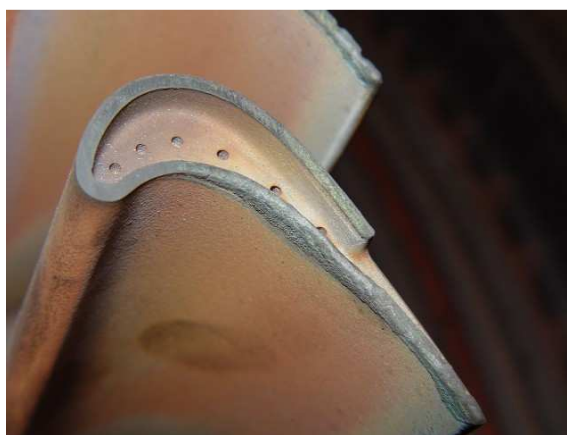
Erosión y Oxidación Tip álabes 1° Etapa
