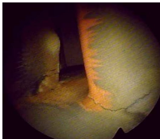
Grieta – Fatiga Térmica álabe etapa turbina
