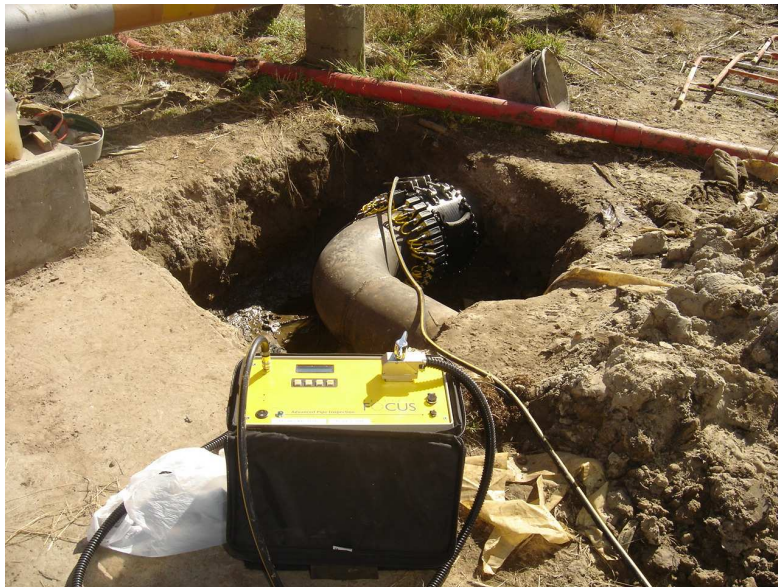
Figura 7: Ubicación del ensayo aguas debajo de un codo
