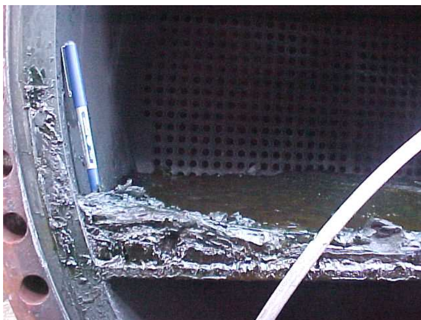
Figura 6. Depósitos hallados en el mazo de tubos E-183 A/B
