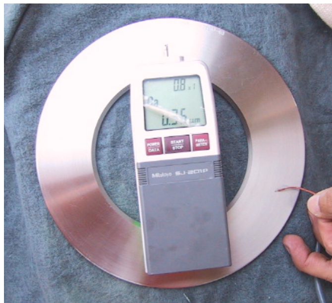
Foto 2. Verificación Rugosidad Placa
