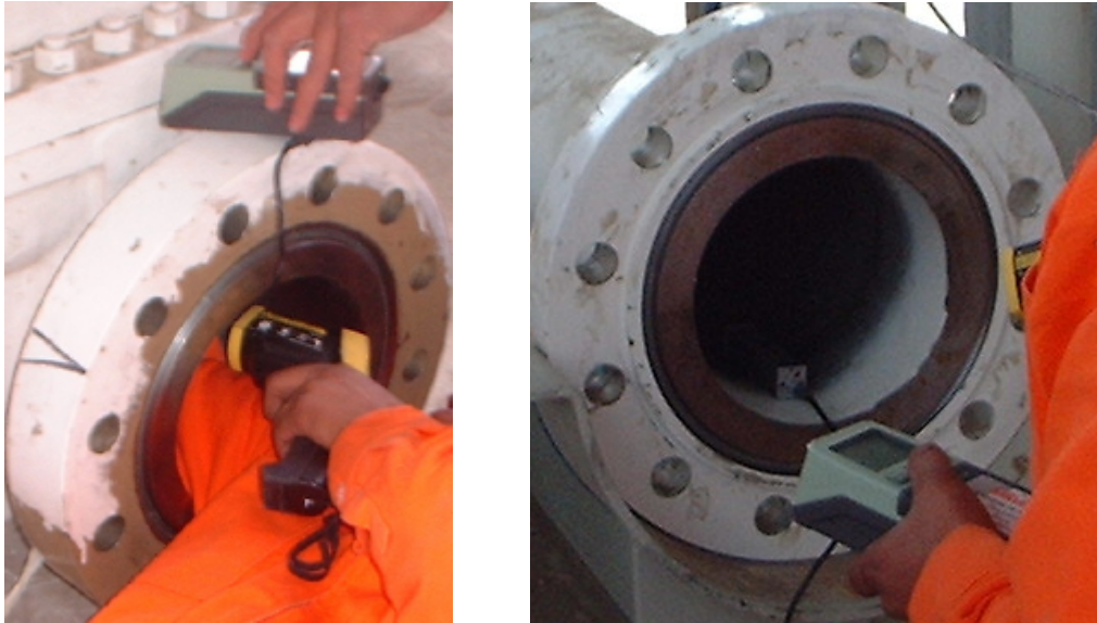
Foto 5. Verificación Rugosidad Tubo de Medición
