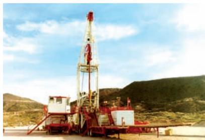
Figura 6. Equipo Coiled Tubing Drilling – 02 (CTD -02).
