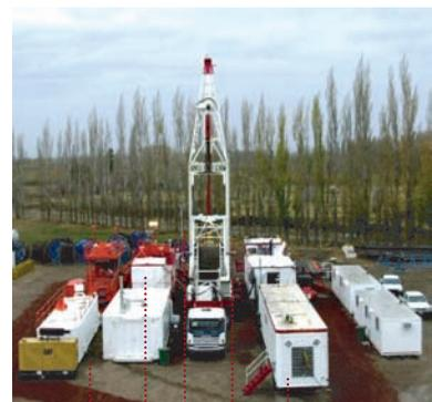
Figura 7. Layout de la locación para el equipo CTD 02.
