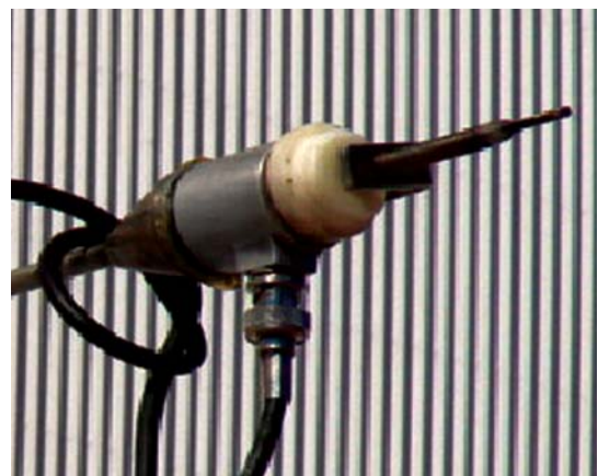
Guía de onda y sensor de EA.
