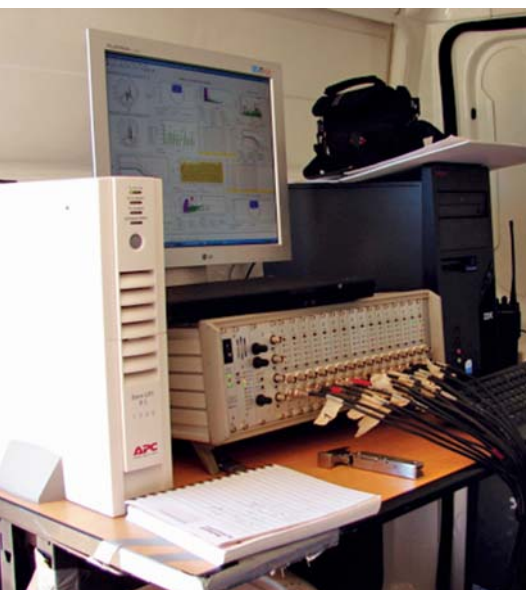
Procesador para almacenar los datos de EA.
