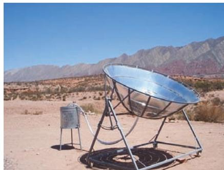
Figura 5. Pasteurizador de leche de cabra para la fabricación artesanal de quesos en Amblayo, Salta.
