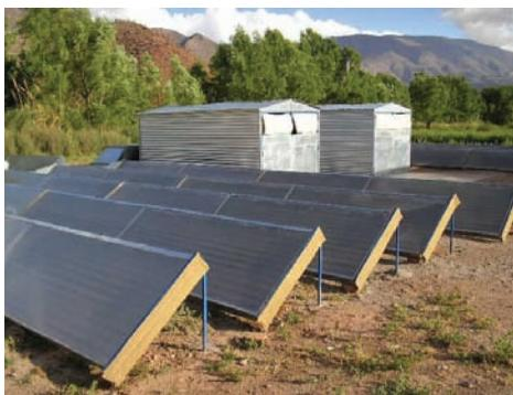
Figura 3. Secador solar de productos agrarios instalado en la Quebrada de Humahuaca, Jujuy. Posee un área de colección de 200 metros cuadrados y dos cámaras de secado.
