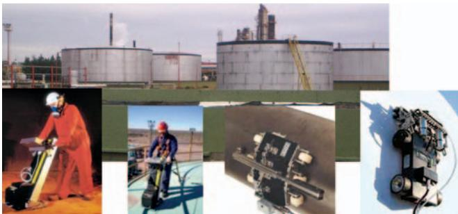
Único sistema en el país capaz de detectar disminuciones de espesor en chapas de acero con total precisión tanto en la ubicación como en la magnitud del defecto. Resultados expresados en un fácil y claro mapeado interactivo.
