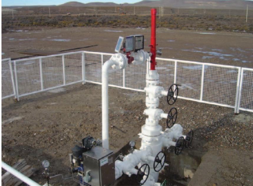
Instalaciones de superficie de un pozo con *Plunger Lift*.
