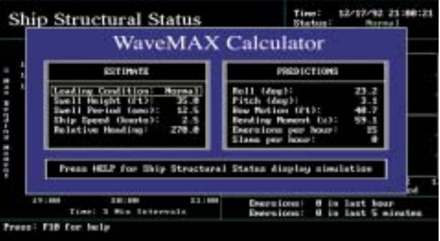
Calculador de oleaje WaveMax, que muestra estimaciones de altura, período y dirección de oleaje y predicciones de movimientos, momento flexor y emersiones de la proa.
