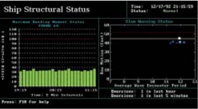
Pantalla que muestra el máximo momento flexor, la correspondiente sección del buque y la predicción de slamming.
