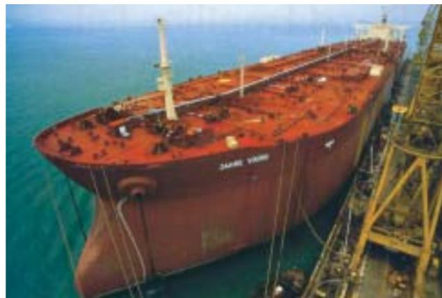
Viking". Se trata, por sus dimensiones, del buque petrolero más grande del mundo: 564.763 DWT, 458,5 m de eslora, 68,8 m de manga y 24,6 m de calado. Puede transportar aproximadamente hasta 650.000 m<sup>3</sup> de crudo (unos 4,1 millones de barriles). (<http://exchange.dnv.com/> "Register of Vessels").
