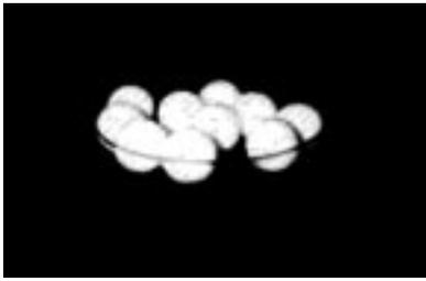
Figura 9 • **Pellets de hidratos de metano, que permitirían su transporte en modo seguro y económico desde instalaciones en alta mar.**
