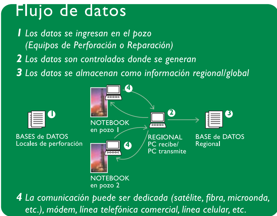
Figura 3 • Flujo de Datos General de Perforación
