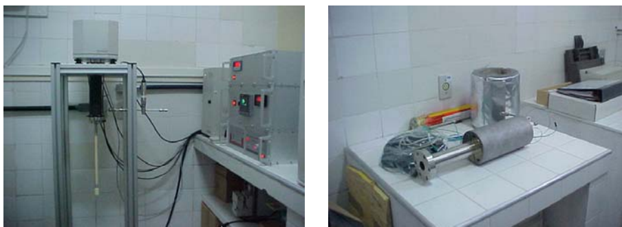
Figura 2. Equipamentos para medidas de adsorção - microbalança (sem a célula termogravimétrica) e célula termogravimétrica, respectivamente
