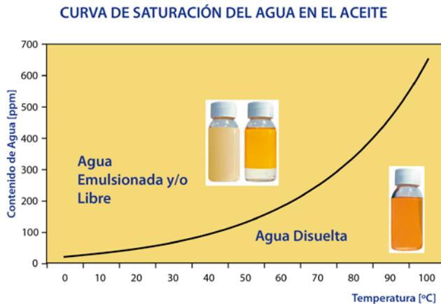
Fig. 5. Curva de saturación del agua en aceite de turbina mineral.
