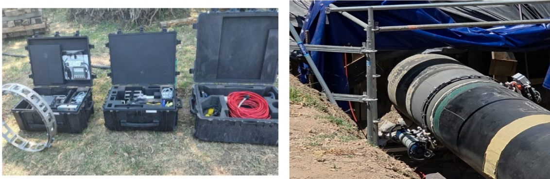
Figura 2: Detalle del equipamiento utilizado para llevar adelante la técnica de END ADR en el caso que se presenta.
