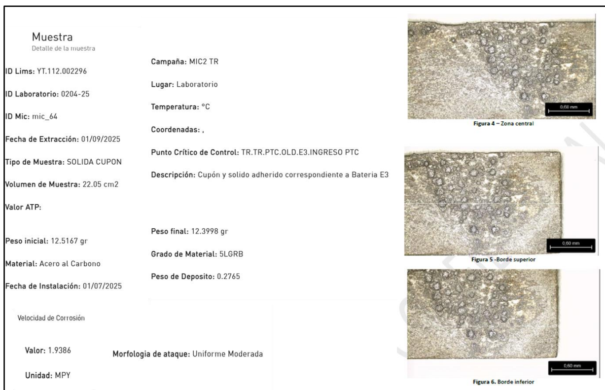
Figura 7. Reporte análisis de velocidad de corrosión y morfología de ataque.
