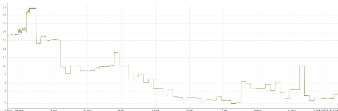
Figura 7: Concentración de sales a la entrada de la torre AP-T-1 en PTB durante el lapso de tiempo que se inyectó el shock de dispersante de sales.
