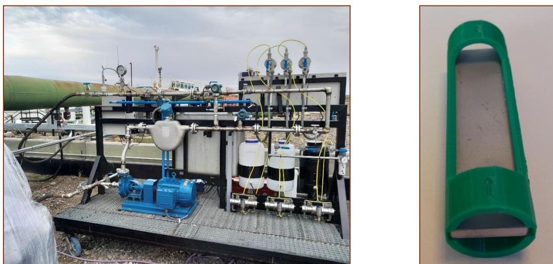
Figura 1 – Equipo sidestream, a la izquierda; y cuponera con cupón de acero al carbono insertado, el área de los cupones es de 55 cm 2 .
