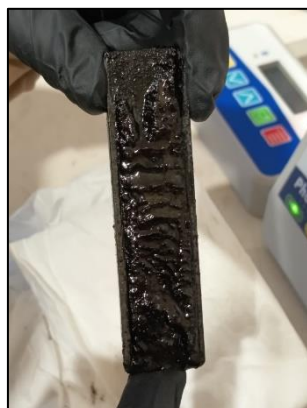
Figura 2 – Foto de un cupón extraído al cabo de 10 días. Se observa una gran cantidad de sólidos oleosos.
