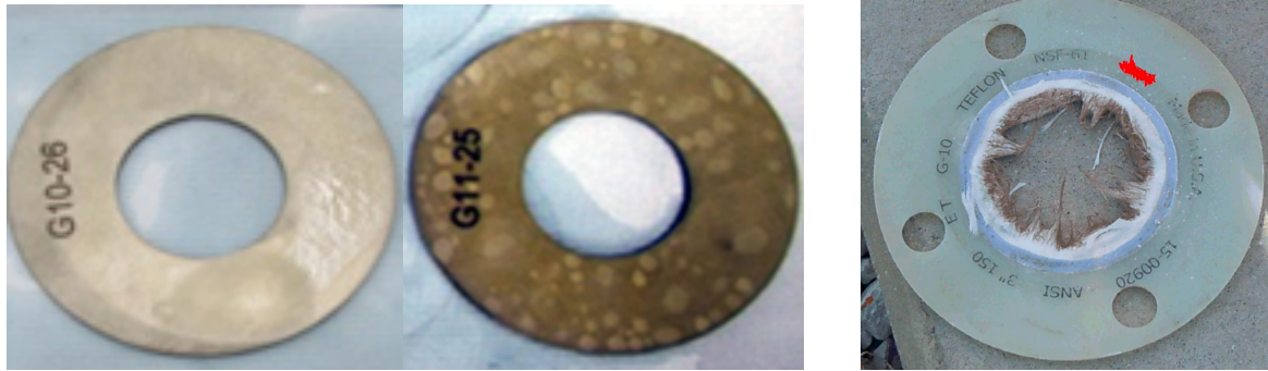
Figura 3. Afectaciones en el G10 y G11 por ataque químico.
