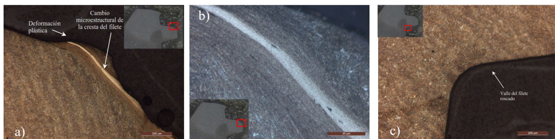
Figura 40. Superficie dañada en la cresta del filete. (a) y (b) X200. Superficie del valle del filete roscado en muestra del conector Straight Joint.
