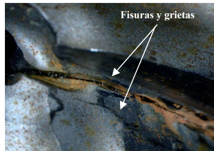
Figura 21. Fisuras, grietas y pérdida de material en conector. Magnificación 8X
