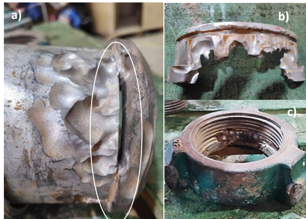
Figura 13. Daños a) Cuerpo del Conector, b) Segmentos y c) Tuerca Mariposa de válvula.
