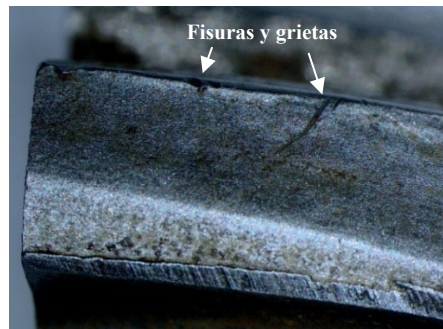
Figura 32. Fisuras y grietas en pieza del conector Straight Joint
