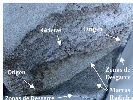
Figura 24. Macrografía en Fisura del conector. Magnificación 10X
