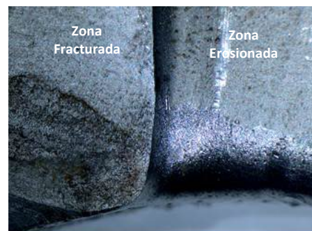
Figura 25. Zona fracturada y erosionada en muestra. Magnificación 8X.
