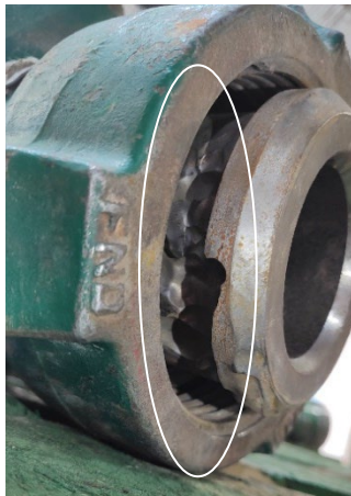
Figura 12. Daños en Conector de Válvula
