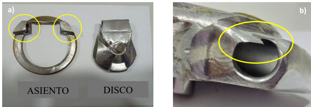
Figura 10. a) Asiento y Disco (Clapeta) de válvula y b) Daño en péndulo del Disco
