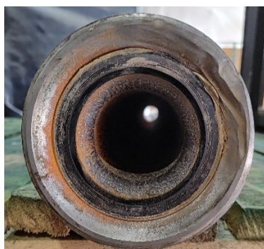
Figura14. Pieza conectora de válvula check lado externo.
