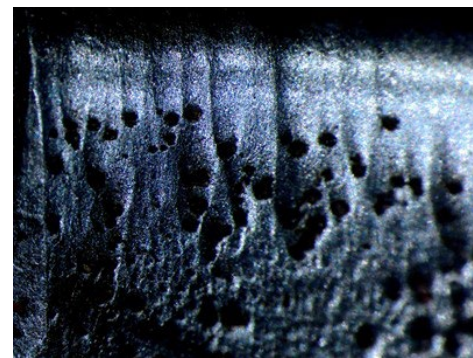
Figura 29. Hoyos redondeados en el material del conector. Macrografía a 16X
