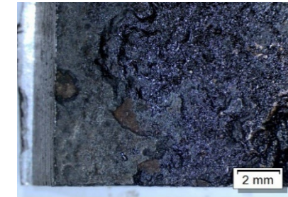
Figura 10 d). Hoyuelo redondeado en borde y coloraciones marrones-rojizas en paredes irregulares adyacentes a zona de falla a 8X
