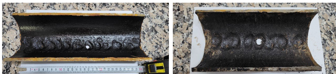
Figura 1. Medias Cañas de Acero a) Material Húmedo adherido a media caña 1 y b) Material Seco adherido a media caña 2.
