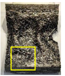
Figura 10 a). Macrografía en zona de falla hacia borde a 8X.
