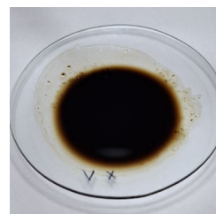
Figura 9. Disolución en Xileno de la muestra. Categoría: muy Soluble
