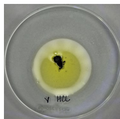
Figura 8. Reacción y cambio de color sin disolución de la muestra en HCl.
